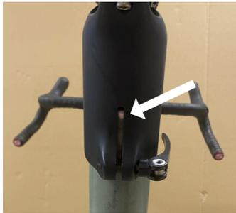
Abbildung 7 maximaler Auszug der Stütze
