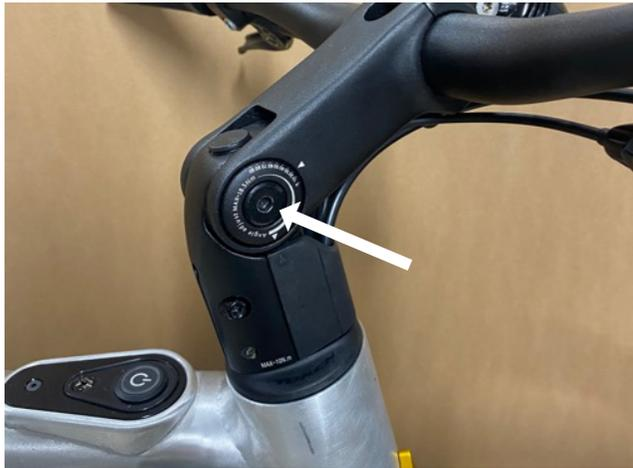
Abbildung 4 verstellbarer Vorbau mit Einstellschraube
