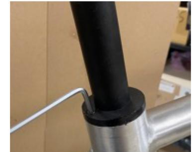
Abbildung 9 Montage mit Inbusschlüssel
