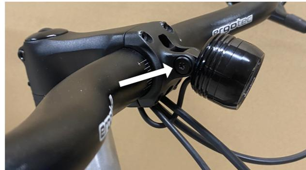
Abbildung 15 Scheinwerferbefestigungsschraube
