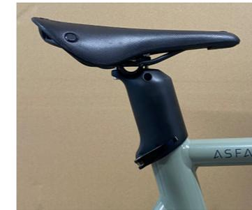
Abbildung 5 Standard Aufsteck-Sattelstütze
