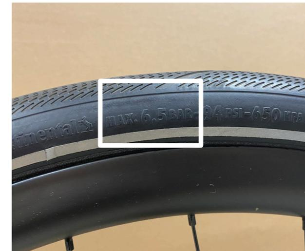
Abbildung 20 Seitenwand Pneu mit Soll- oder Maximaldruck
