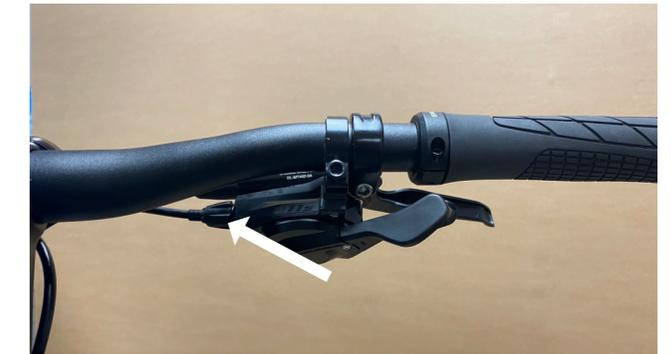
Abbildung 31 Shimano Stellschraube am Schalthebel
